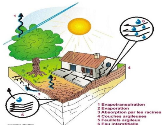
fig. 1 : illustration du mécanisme de dessiccation
